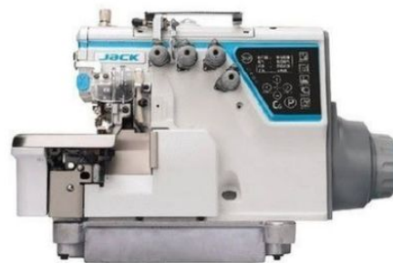
Jack C6 – оверлок з розпізнаванням товщини матеріалу
