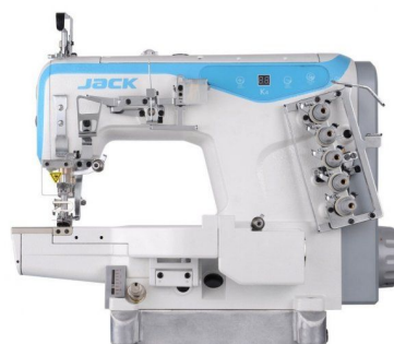
Jack K5 – плоскошовна машина з циліндричною платформою
