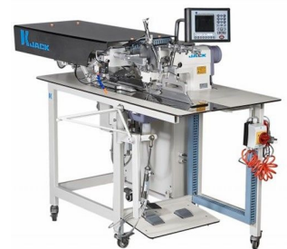
Jack-T5878-58 – машина для виготовлення планки поло
