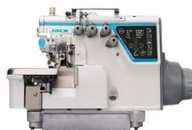
Jack C6 – оверлок з розпізнаванням товщини матеріалу
