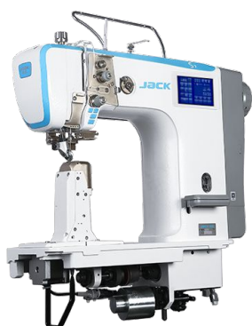
Jack S7-91 – колонкова машина з роликовим просуванням матеріалу
